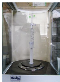
写真3 電子天秤を用いて気体の質量を測定
