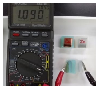
写真6 電解質入り寒天接触型ダニエル電池
