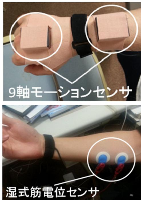
図2 モーションセンサ、筋電位センサ
