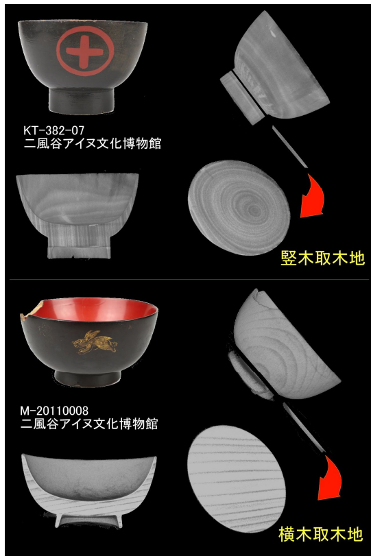
図1 X線CTスキャナによる漆碗の調査例 (製作技法に関する情報)
