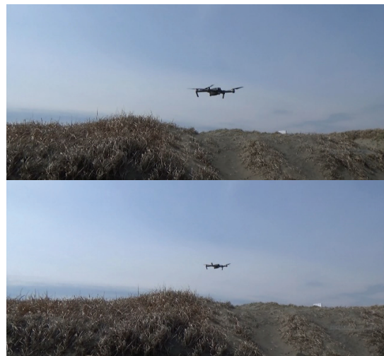
図 5. 飛行試験の様子: 最適航路点を追従し、0.6 m の許容最小高度で斜面を越えている
