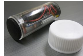
図 3 . 自走機体 (長さ 50mm, ボトル蓋と同等の大きさ)
