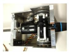
(3) ドライボックスを用いた動作性の確認 ドライボックスを用いたゴム製リングを時 計方向に順にかけて一周に要する時間測定 を行った。被験者は3名。ロボットを用いた 場合とヒトが操作した場合を5回交互に行い 比較した。1回目と5回目の3名の平均を比 較するとロボット:38秒(1回目)22秒(5回目) ヒト:26秒(1回目)18秒(5回目) であった。
