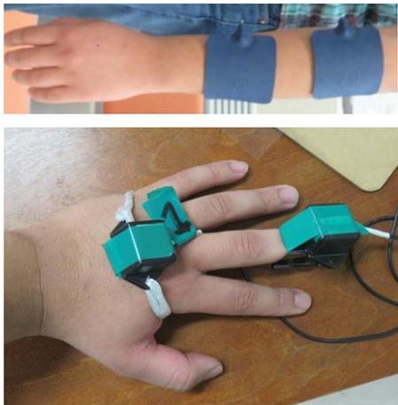
図3：電極と傾斜角度センサの配置
