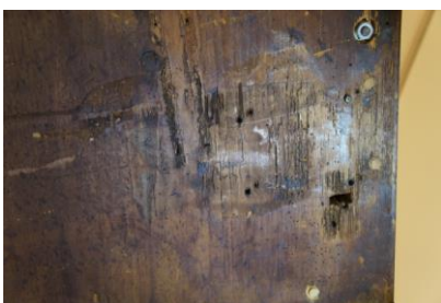
ミュンツェンベルガーの底板に残る第3の膝レヴァーの痕跡
