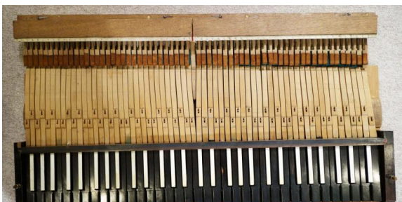
ミュンツェンベルガーの鍵盤 (ダンパー・リフトが2つに分かれている)
