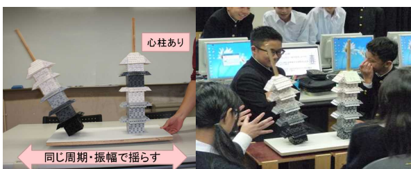
図7 五重塔の振動実験の様子
