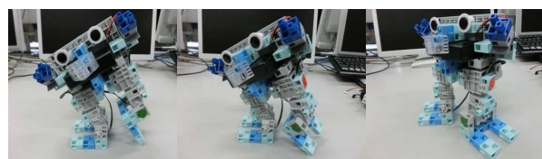
図11 足関節の回転角度を調整したのち歩行するロボット
