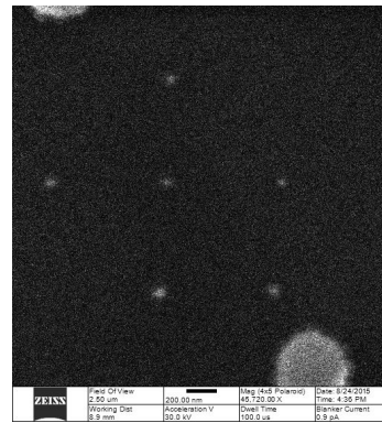
図 4. 電子線リソグラフィー法で作製した基板上に整列した直径 20 nm、粒子間隔 10 nm の Au ナノ粒子対の He イオン顕微鏡像。厚さ 100 nm の絶縁体シリカ層を通しての観察。右下の大きな構造はゴミ。下部のスケールバーは 200 nm に対応。
