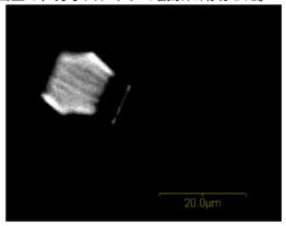
ステップのモルフォロジーは、通常の塩析法によって得られた正方晶系結晶の各面上での観察されているものと比較して、特に大きな変化は見られなかった。ステップカイネティック係数が通常のものよりも小さくなったが、オーダーは同じであった。これらの観察結果から、融液に近い高濃度の溶液からの成長(融液様成長)であるにもかかわらず、従来の溶液成長とステップ上のキンク密度や活性化エネルギーに大きな違いがないことが明らかになった。
