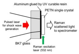
図4 ラマン分光実験で使用したターゲットアセンブリの模式図
