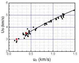
図 3 衝撃圧縮されたペンスリット単結晶 [110]の衝撃波速度(Us)と粒子速度(u<sub>p</sub>)との 関係、 : 本実験データ : 既往のデータ
