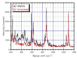
図5 測定されたラマンスペクトル (a): 常温常圧状態、(b): 衝撃圧縮状態
