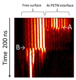
図 2 ストリークカメラで記録された 画像の例
