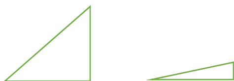
直角三角形を垂直に潰しても Lagrange 補間の精度は劣化しない。
