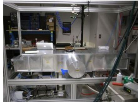
図 4：ハワイ観測所に設置した面分光機能追加のための MOIRCS 焦点部筐体。この筐体を用いて、面分光ユニット全体の冷却試験を行った。
