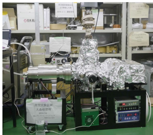
図5 試作器の真空試験セットアップ
