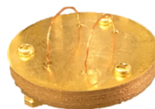
図 4 RF コイルを設置した薄膜平面ミラーの写真
