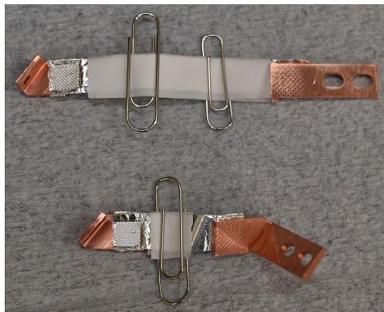
図 2 改良型冷却用銀薄膜リボン。銀箔の部分は保護のため紙で巻いてクリップ止めしてある。ハッチングの部分が銀と銅を超音波接合した部分。
