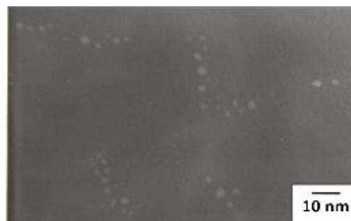
図6 カリミョウバン水溶液中の金ナノ粒子
