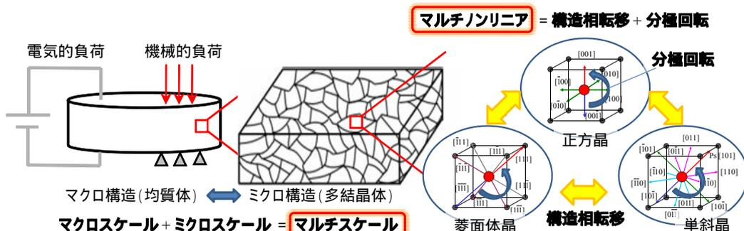
図1 構造相転移と分極回転を考慮したマルチスケール・マルチノンリニアモデリング
