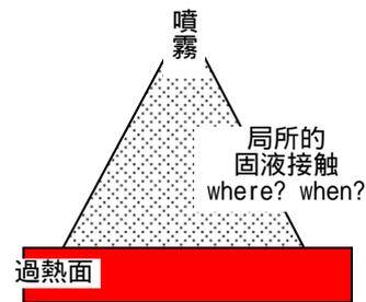
図1. 噴霧冷却系での固液接触
