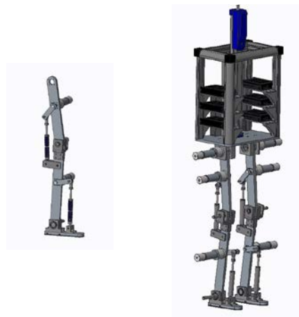
図4 SEA の機構とそれを用いた走行ロボット
