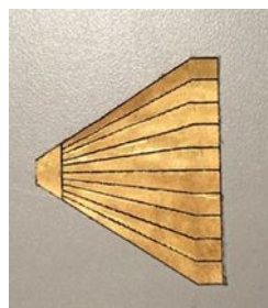
図2 レーザパターンニングにより製作した素子例
