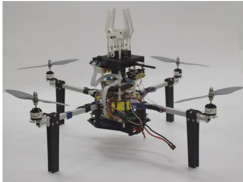
図4 上向きハンドを搭載した飛行ロボット
