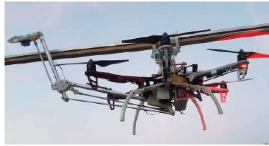
図5 機体固定用ハンドと作業用マニピュレータを搭載した飛行ロボット
