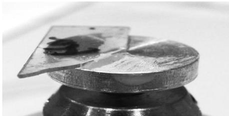
図1 劈開させた断面を測定する試料の例断面が平らではないため、試料によるビームの半割が出来ない。下の円盤状のものはサンプルホルダー。
