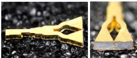
図11 完成したE面2分配器とホーンアンテナの一体構造
