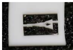
図10 分配器一体化アンテナのテフロンパターン
