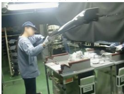
図3 作業員による外観検査
