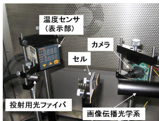
図7 測定実験系の光学部（恒温槽内に設置）
