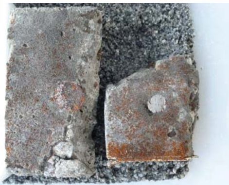
写真) 採取してきたコアを切断して鉄粉散布法に供している様子。鉄粉の発錆境界の位置と内部に埋め込まれている鉄筋の腐食状態との関係を観察する。
