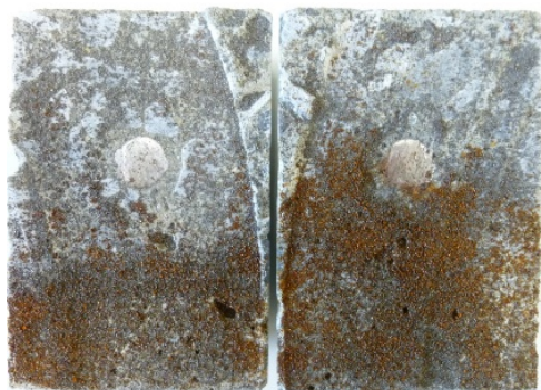
写真) 科研費申請段階で考案していた鉄粉散布法の実施例。塩化物イオンが浸透しているコアの切断面に鉄粉を散布して、高湿度の密封した箱内に数日以上おいておけば、鉄粉に赤錆が生じる領域と生じない領域とに分かれる。双方の領域の境界＝コンクリート中の塩化物イオン濃度が鋼材腐食発生限界塩化
