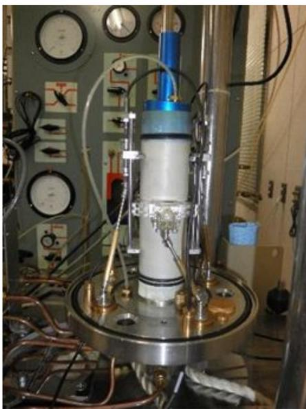
Fig. 4: 局所変位計取付概要
