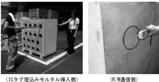
写真2 通信性の調査の様子
