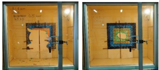
図8 ガラスの破壊形状 (左) 衝突速度 14.2m/s (右) 衝突速度 23.6m/s
