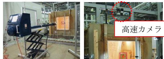
図7 (左) 実験実施時の全体状況 (右) 下向き高速カメラの設置状況
