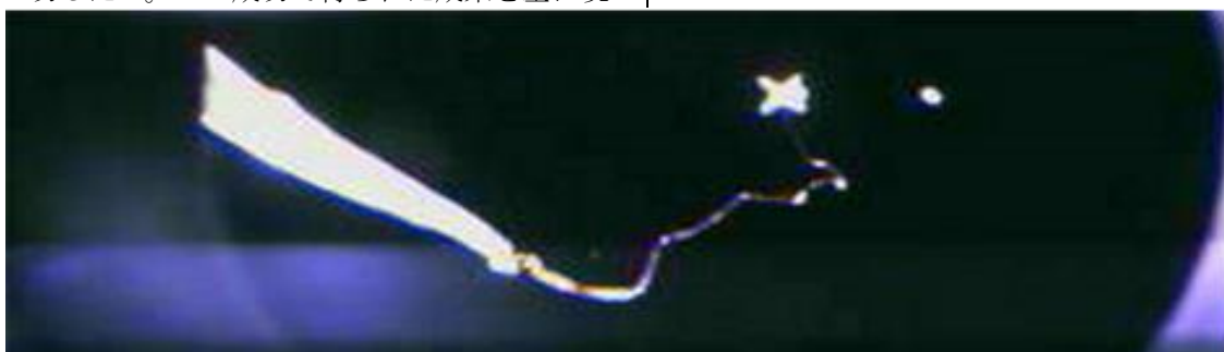
図1. 宇宙で伸展したスーパー・テザー 放出された副衛星からの画像（星印のように見えるものは分離したロケットのノーズコーン）
