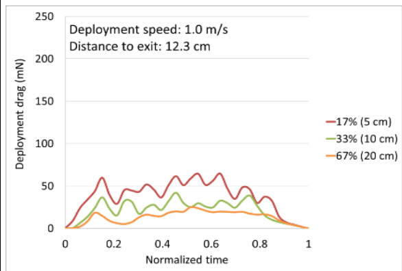
図5 出口までの距離が 12.3 cm（高い）時の展開抵抗の時間応答
