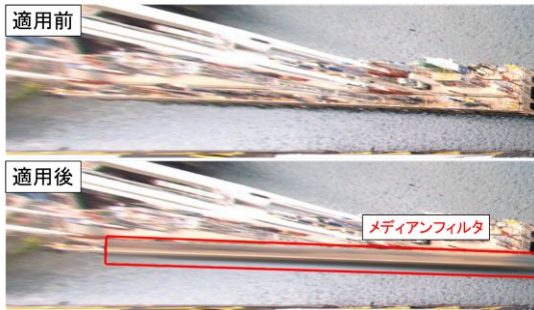
Fig. 7 メディアンフィルタによるノイズ除去
