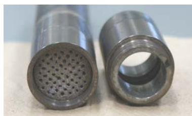
図 3 試作したハニカム状脱硫剤の外観（マイクロリアクタ試験用サンプルホルダにセットした状態）
