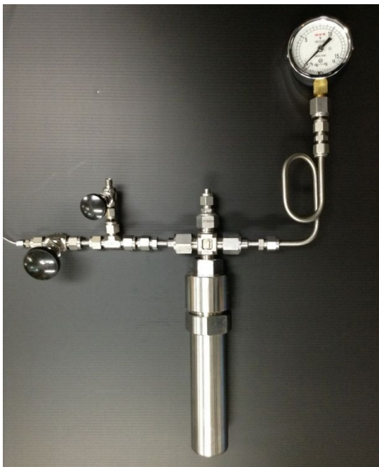
図1．ステンレス製の高压容器．中央上部から試料内へステンレス管がのびており、そこにボアスコープをいれることで試料を観察できるように設計した。
