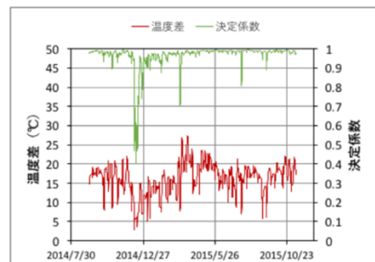
図4 評価期間96時間の温度差と決定係数 ( R^2 ) の変化
