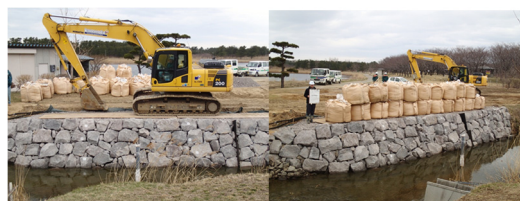
図8 荷重試験（左：重機、右：重り）
