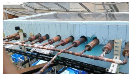
(c) 太陽熱集熱器 (冷媒の吸着と脱着)
