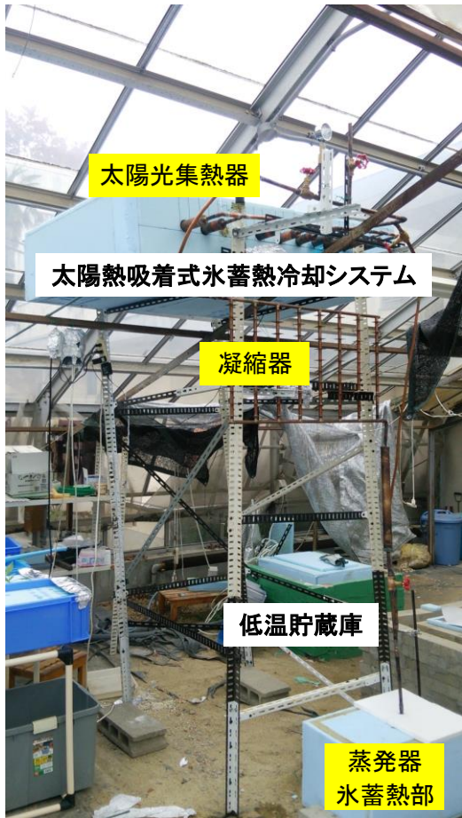
(a) 全体 (太陽熱吸着式氷蓄熱冷却システム含む)
