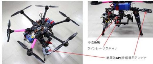
図 5 試作システムの外観
