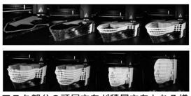
マスク部分の頭尾方向が積層方向となる様にポリゴンデータを配置した。
