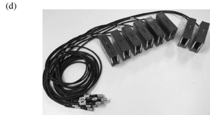
図4 開発した8チャンネルX線エネルギー測定器(文献)
