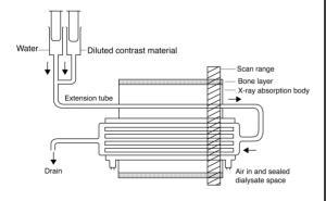
このファントムに一定の条件で造影剤のボーラスを流した場合の理論的な脳血流パラメータは、理論的に算出することができる。この値を実際の CT 装置で撮影および解析をした測定値と比較することで、定量性の精度を検証することができる。
