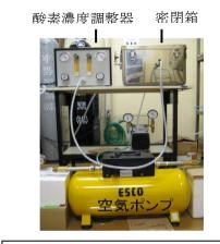
図6 酸素曝露動物飼育装置(福井大学生物資源部門設置)
