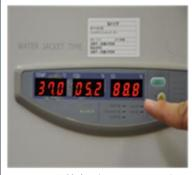
図 5 培養細胞に 5~89% 濃度の酸素を曝露する CO2 /マルチガスインキュベータ ー(写真では酸素濃度が 88.8%に設定されている)
