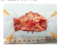
一方、外側は一部 stent 骨格が露出している部分があった。また、植え込み中の動物の体動などが影響していると考えられる stent 骨格の変位が認められ、Z-stent 展開時にままの形態を維持することは困難であった。
