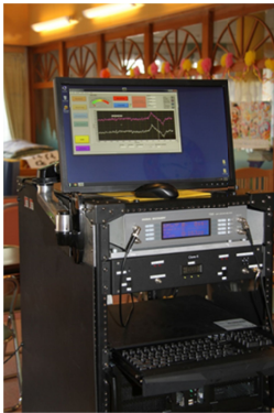
写真3 計測装置 計測コンソール、磁石は、小型化し、キャスターで移動可能な構造。比較的小型のトラック等で運搬が可能である。配線接続は約10分程度。マグネットの重量は約30kg。100V家庭用商用電源で、安定動作ができる。消費電力は、450W程度。
