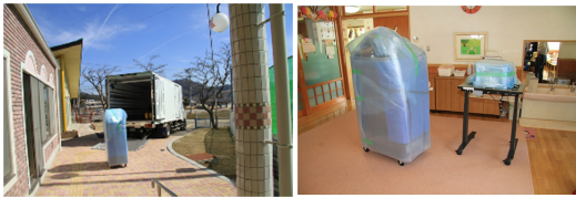
写真3 計測装置 計測コンソール、磁石は、小型化し、キャスターで移動可能な構造。比較的小型のトラック等で運搬が可能である。配線接続は約10分程度。マグネットの重量は約30kg。100V家庭用商用電源で、安定動作ができる。消費電力は、450W程度。
