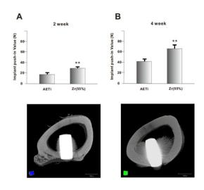
フッ酸処理により新規に創生したナノ構造体を持つナノジルコニア表面に対し、紫外線照射の効果を検討するための基礎研究とさらに臨床応用へと展開するため in vitro の動物実験を行った。まず、紫外線照射試験の確認のための全実験を再度行った。チタンの酸処理表面を対照群として55%フッ酸処理をしたナノジルコニアのミにインプラントをラットの大腿骨へ埋入し、その骨結合能を力学的、組織学的に検索した。(push in test)その結果埋入2週間後、4週間後の埋入初期の骨結合能はともに酸処理チタンに対し2倍の値を示し有意に上回った。またマイクロCT画像による組織学的な観察では
