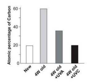
ナノジルコニアへの紫外線処理は骨芽細胞に対し、その接着、増殖、伸展、分化を促進した。フッ酸処理をしたナノ構造体を持つジルコニア表面への紫外線による光触媒効果は十分にノーマルな表面に対する効果と同様に有効であることが分かった。また光触媒効果のうち、表面の超親水性化に対してはUVA,UVCがともに効果を示したのに対し、表面有機物の分解への効果は低波長で高エネルギーのUVCがその効果が高いことが
