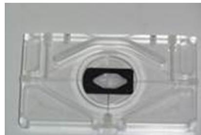
図4：今回新たに試作してもらったカセット。下部は顕微鏡観察可能なプラスチック素材、上部は表面に黒い両面テープでガス透過膜を張り付けた
