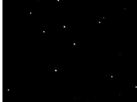
図 3. 風洞実験で捕集された蛍光ビーズの蛍光顕微鏡画像
