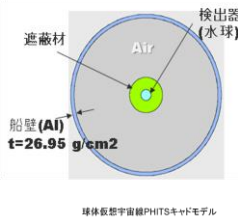
図1 シミュレーションモデルに用いた遮蔽体系
