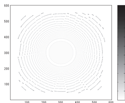
図 3. Gelatin 内で安定化された Ag イオンの還元反応を組み込んだ反応拡散方程式から得られた空間構造形成の数値計算結果。
